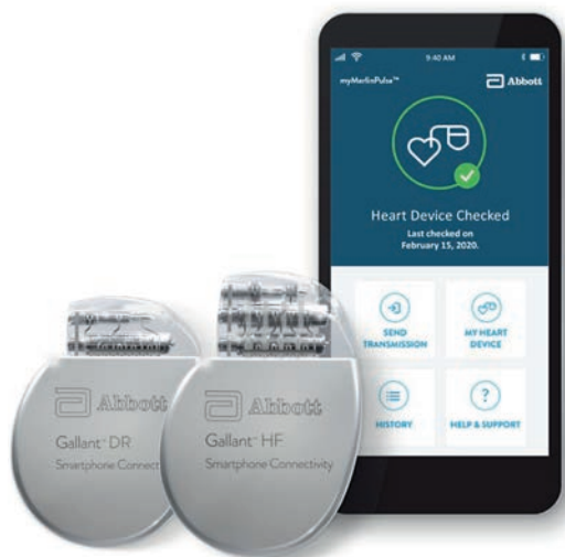
Figur 4. Fjärrövervakningssändaren skickar automatiskt information till sjukhuset om betydande arytmier och onormala pacemakeravläsningar. I några av de senaste pacemakerarna kan patientens egen smarttelefon användas som sändare. Bilden visar en tillverkares applikation. Bild med tillstånd av Abbott.
