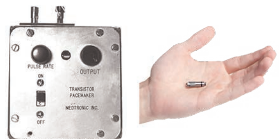
Figur 2. Till vänster en extern pacemakergenerator från 1958. Till höger en trådlös pacemaker som är lika stor som en vitaminkapsel. Bild med tillstånd av Medtronic.
