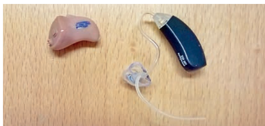
Figur 1. En conchaapparat och en bakom-örat-apparat med tunnslangstipp.
