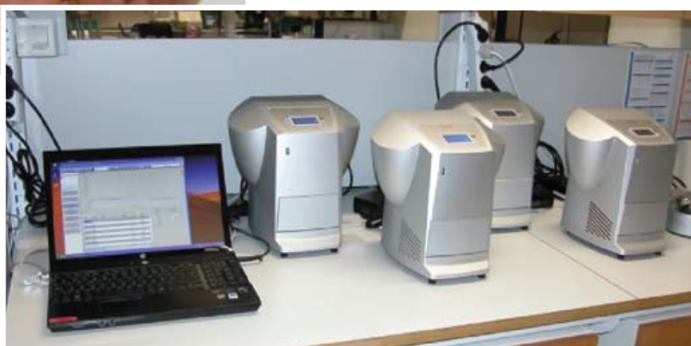
Figur 3. PCR-amplifiering och analys av smältkurvan görs i 10 \mu l- reaktioner. Då 16 gener analyseras, fördelas varje prov i 48 gropar. Reaktions- volymen är 10 \mu l, och pipet- teringen sker med robot för att eliminera fel och påskynda analysen.
